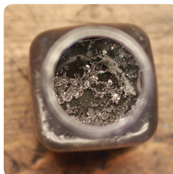
Olie aftappet fra en sammenbrændt kompressor. De synlige forureninger er spredt rundt i hele systemet, inklusive kondensoren.
