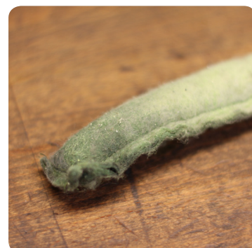
Hvis filteret (eller tørremiddelpatronen) er opslidt, resulterer det ofte i tilstopning af kondensorens indvendige rør
